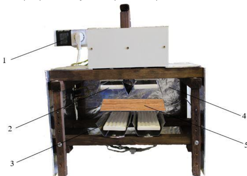
Рис. 1. Загальний вигляд пристрою для прогрівання пакета інфрачервоним випромінюванням: 1 – пристрій для вимірювання витрати електроенергії; 2 – інфрачервоний випромінювач; 3 – рефлектор інфрачервоного випромінювача; 4 – стінка камери пристрою з відбиваючою поверхнею; 5 – пакет шпону
