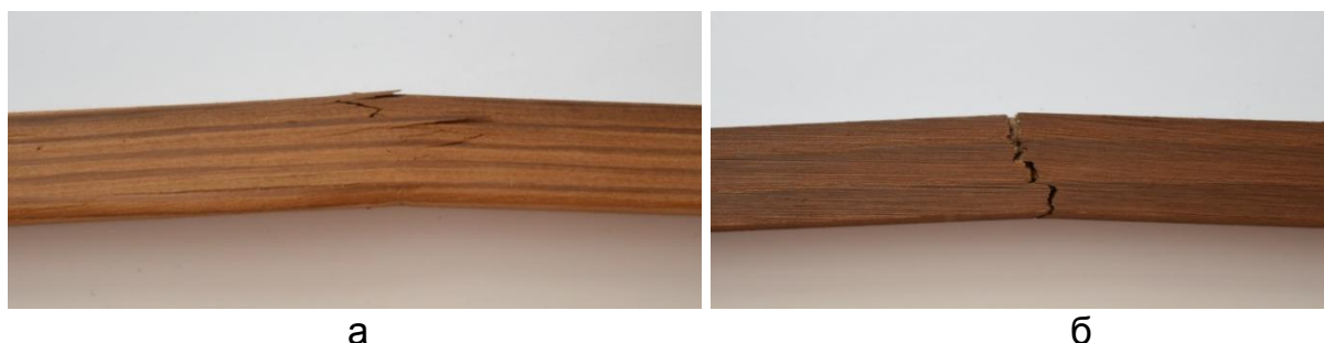
Рис. 6. Вид зламу зразків термомодифікованої деревини: а – сосна; б – ясен
