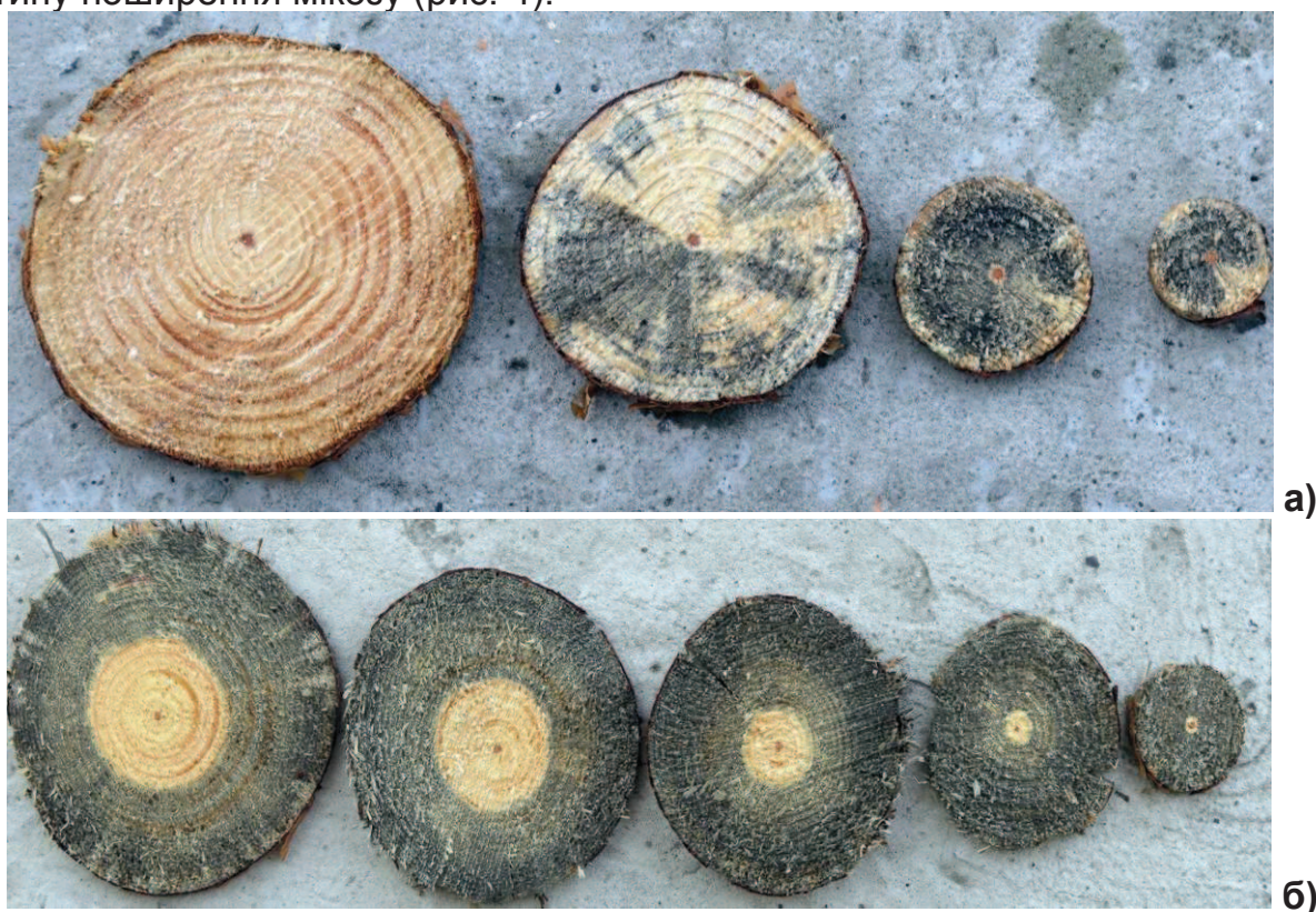
Рис. 4. Поперечні перерізи модельних дерев, уражених мікозом:
