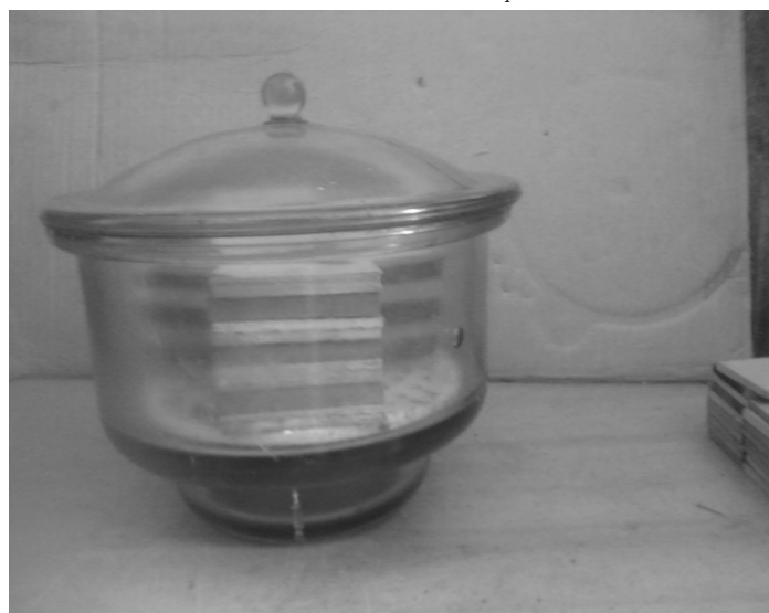
Рис.1. Розташування зразків у гігроскопічних чохлах, розміщених в ексикаторі, зарядженому водою
